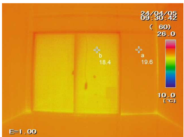
③断熱内窓住戸
